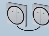
Getrennte Bauweise, Leser außen, Steuerung im geschützten Bereich
